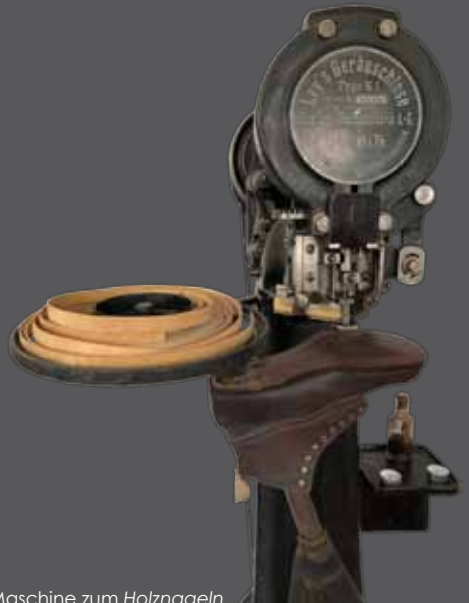
Maschine zum Holznageln das Befestigen der Sohle am Oberteil
